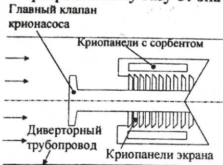
Рис. 3. Структура системы откачки продуктов термоядерного синтеза в ITER.
