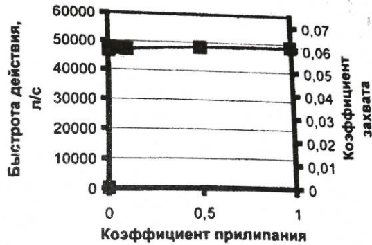
Рис. 5. Зависимость скорости действия и коэффициента захвата системы откачки от коэффициентов прилипания газа на криопанелях насоса.
