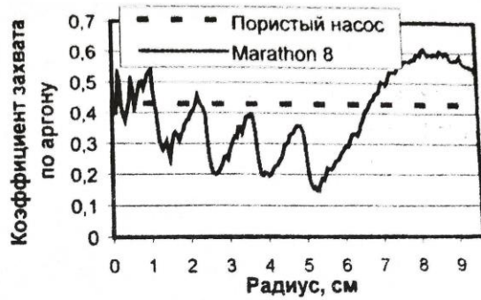
Рис. 11. Распределение коэффициента захвата насоса Marathon 8 по входному сечению.
