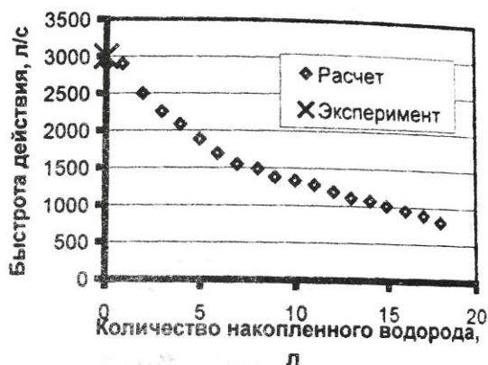
Рис. 2. Рассчитанная зависимость скорости действия крионасоса по водороду от накопления и сравнение с экспериментальными данными.
