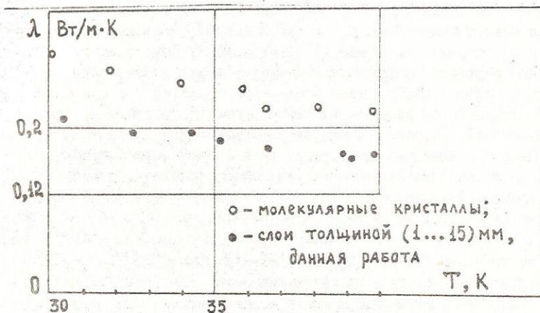
Рис. 8. Сравнение результатов по коэффициенту теплопроводности твердого азота.  $\circ$  - данные Колоскова Л.Н.
