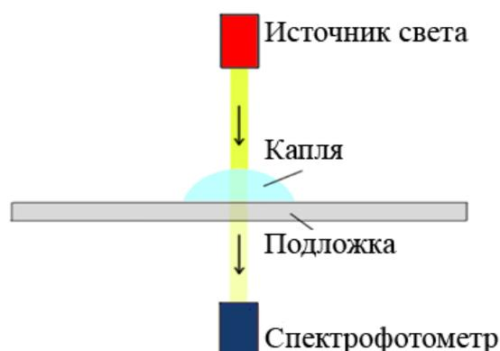
Рисунок 2. Схема размещения элементов установки относительно исследуемого образца
