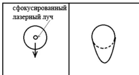
Рисунок 9. Схематическое изображение движения контактной линии капли при движении вертикально ориентированного луча лазера по плоскости основания капли
