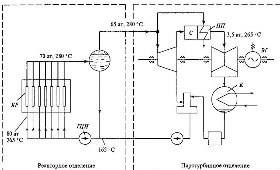
Рис. 5.15. Схема одноконтурной АЭС с канальным реактором РБМК (приведенные цифры относятся к РБМК-1000)
