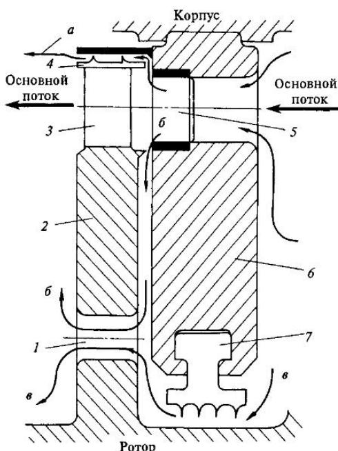
Рис. 10.2. Протечки в ступени турбины:
