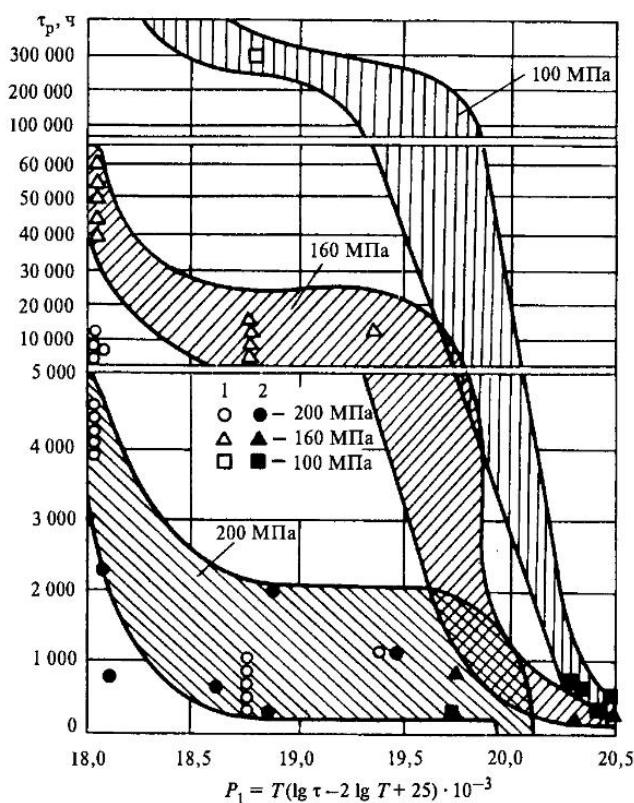
Рис. 12.4. Кинетика изменения длительной прочности роторной стали Р2МА в процессе длительной эксплуатации (анализ докт. техн. наук В.Ф. Резинских)
