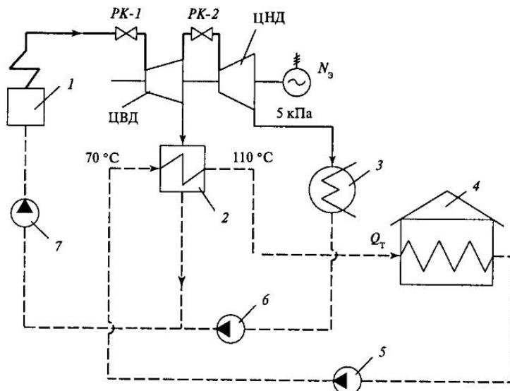
Рис. 3.10. Схема отопительной ТЭЦ с теплофикационной турбиной:
