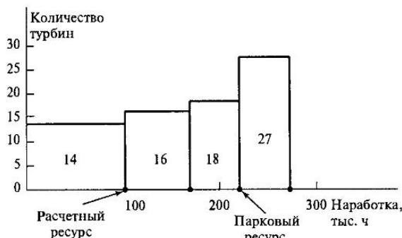
Рис. 9.6. Распределение турбин типа К-200-12.8 по наработке
