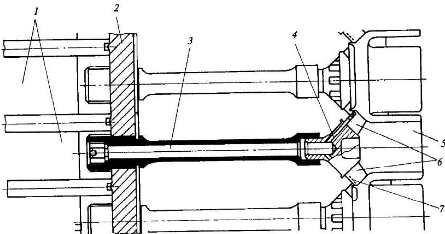
Рис. 7.14. Горелка кольцевой камеры сгорания (проект ЛМЗ):
