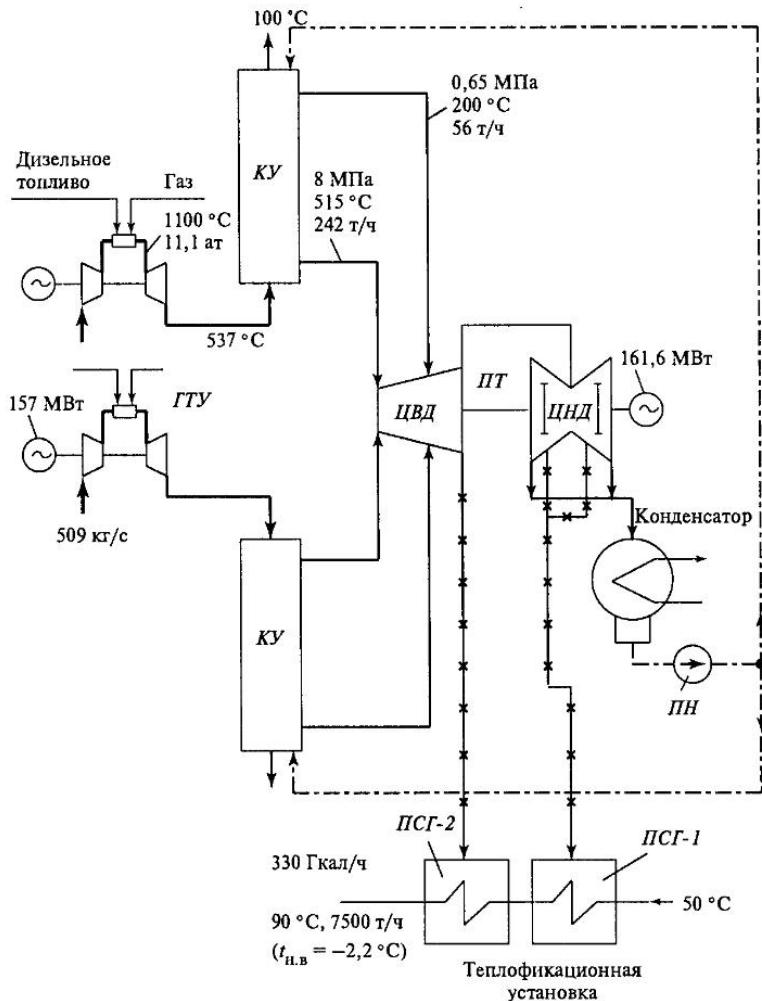
Рис. 13.1. Структурная схема энергоблока ПГУ-450Т
