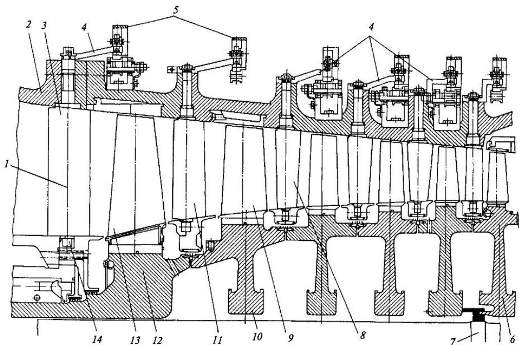
**Рис. 7.6. Входная часть воздушного компрессора (проект ЛМЗ):**
