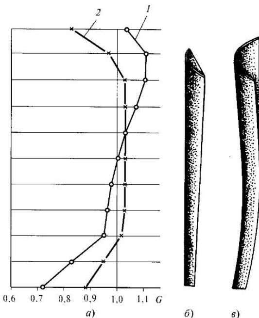
Рис. 10.4. Распределение относительного расхода пара  $G$  по высоте ступени (а), сопловая лопатка старой (б) и улучшенной (в) конструкции:
