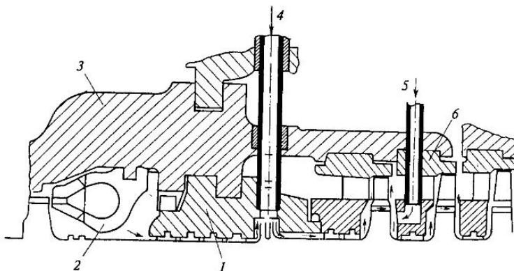
Рис. 11.6. Схема универсальной системы охлаждения ротора с совмещенным ЦВСД японской турбины фирмы Toshiba мощностью 700 МВт на параметры 24,1 МПа, 593 °С/593 °С:
