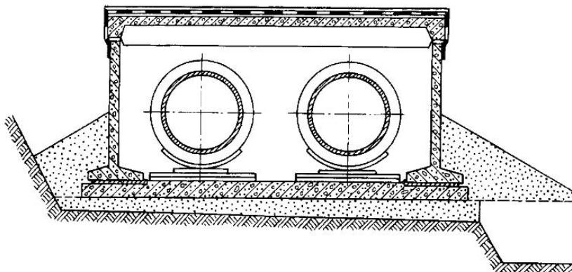
Рис. 3.7. Железобетонный полупроходной канал
