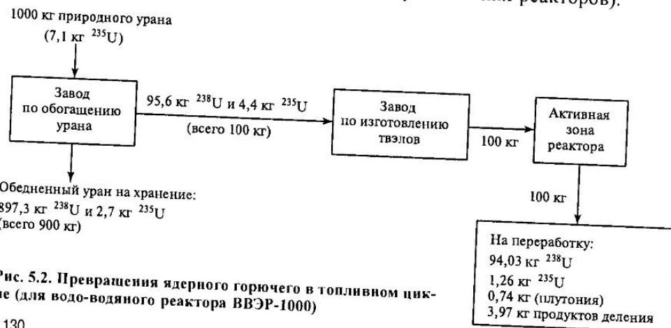
Рис. 5.2. Превращения ядерного горючего в топливном цикле (для водо-водянного реактора ВВЭР-1000)
