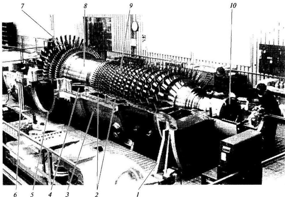
Рис. 14.3. Ротор ГТУ 94.2, уложенный в нижнюю половину корпуса ГТУ:
