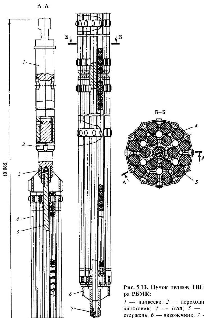
Рис. 5.13. Пучок твэлов ТВС реактора РБМК:
