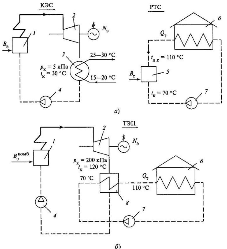
Рис. 3.9. Схемы раздельной (а) и комбинированной (б) выработки тепла и электроэнергии:
