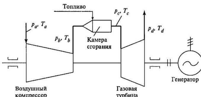
Рис. 7.2. Схема ГТУ простой схемы в условиных обозначениях
