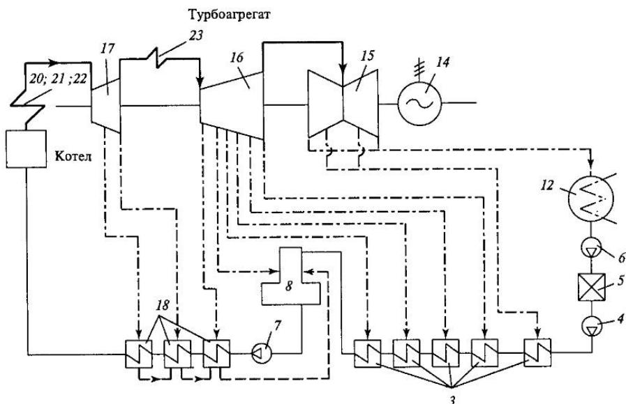
Рис. 2.5. Тепловая схема паротурбинной установки ТЭС, приведенной на рис. 2.2 (обозначения — см. в подписи к рис. 2.2)
