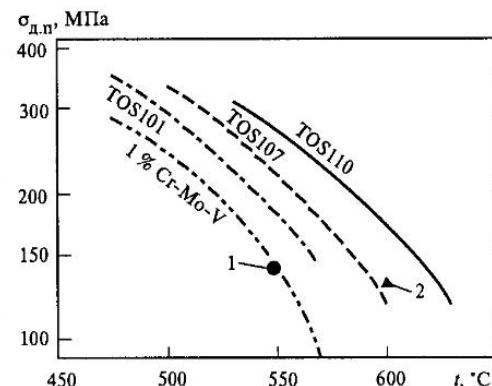
Рис. 11.5. Сравнение длительной прочности японских роторных сталей с отечественными:
