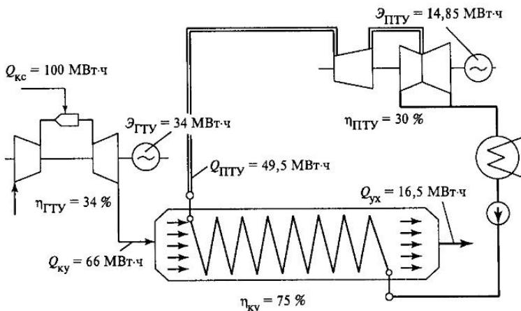
Рис. 8.2. Превращения теплоты в работу в простейшей ПГУ утилизационного типа
