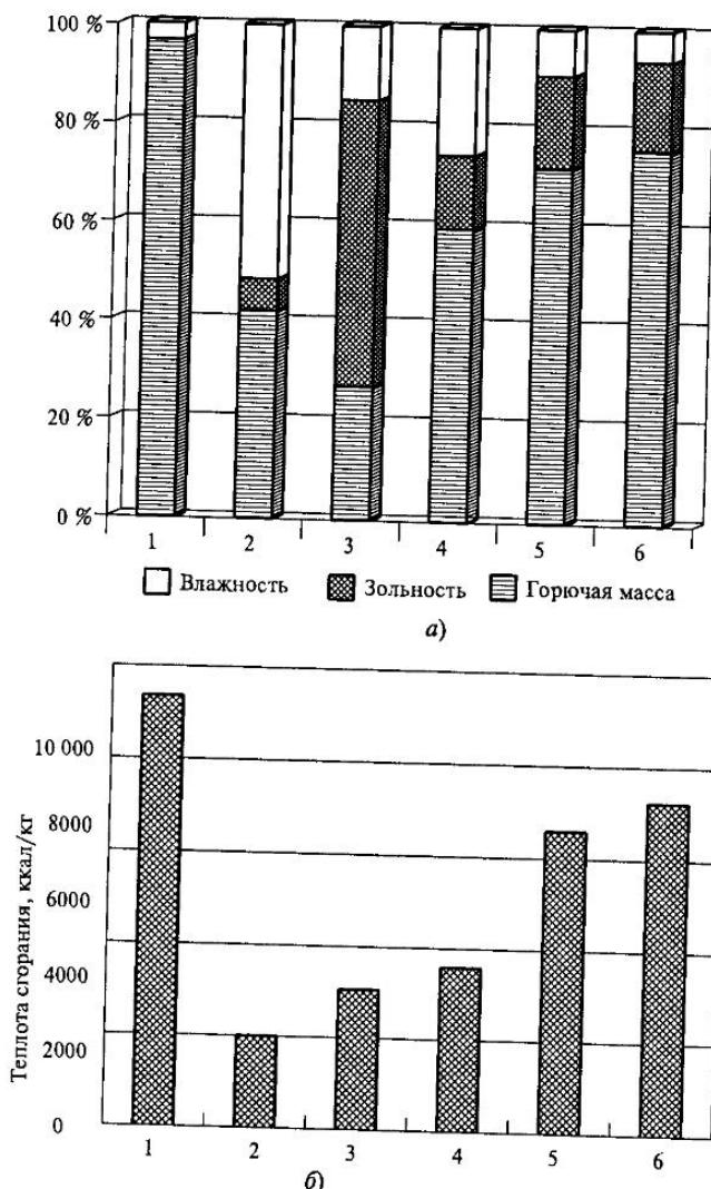
**Рис. 1.5. Сравнительные характеристики мазута и твердых топлив:**
