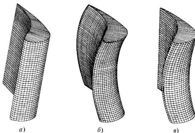
Рис. 10.6. Три последовательные модификации профильной части рабочих лопаток умеренной длины фирмы GEC-Alsthom
