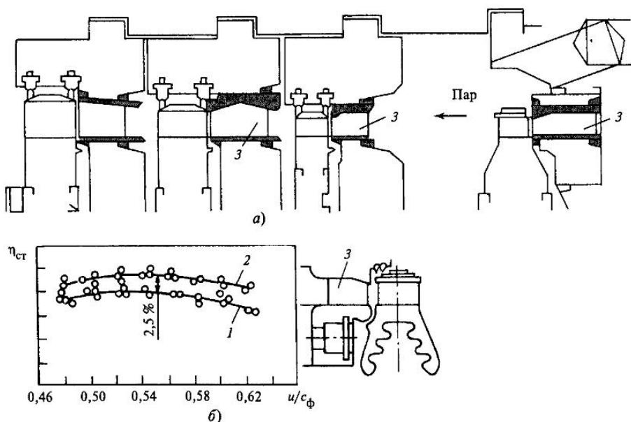
Рис. 10.7. Использование меридионального профилирования в первых ступенях паровых турбин фирмой General Electric (а) и выигрыш в КПД ступени (б):
