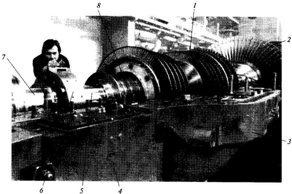
**Рис. 6.7. Нижняя половина статора турбины с уложенным в подшипниках ротором:**
