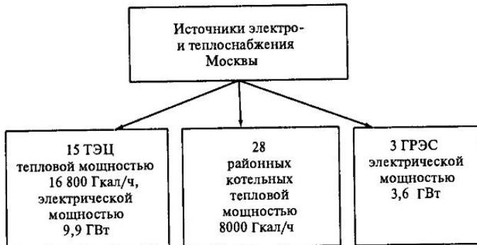
Рис. 3.11. Структура источников электрической и тепловой энергии Москвы
