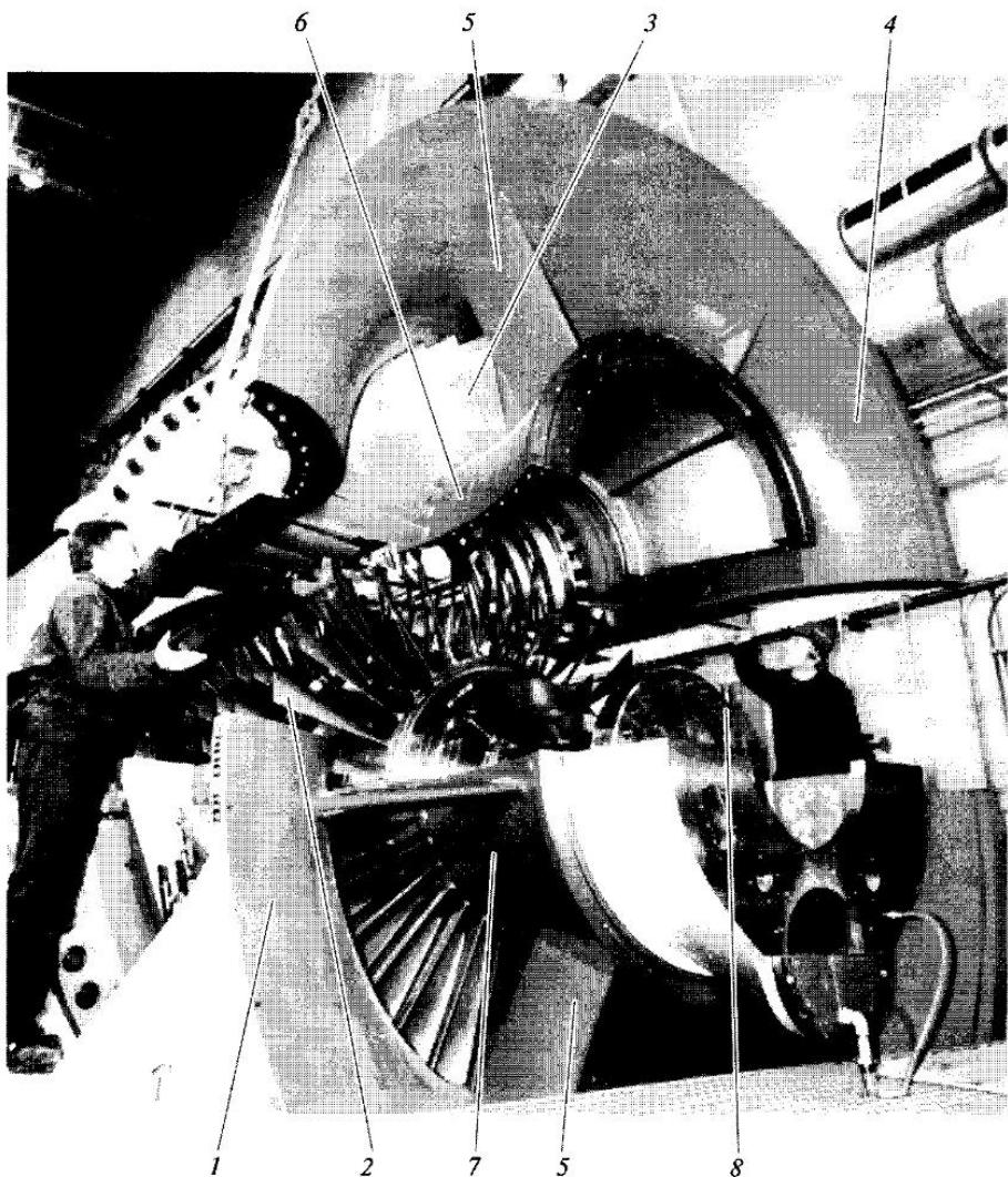
Рис. 14.4. Закрытие корпуса компрессора при монтаже ГТУ на сборочном стендe завода:
