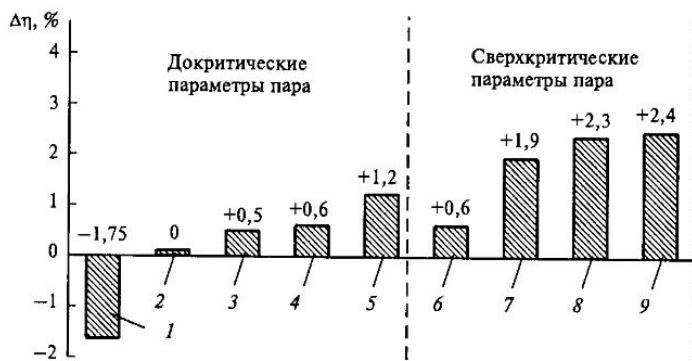
Рис. 8.10. Влияние параметров паротурбинного цикла на изменение абсолютного КПД ПГУ (по данным фирмы Siemens):
