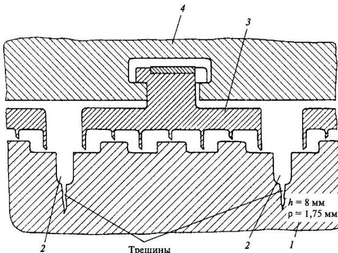
**Рис. 12.7. Кольцевые трещины малоцикловой усталости на поверхности ротора турбины, возникающие в результате циклических температурных напряжений от пусков:**
