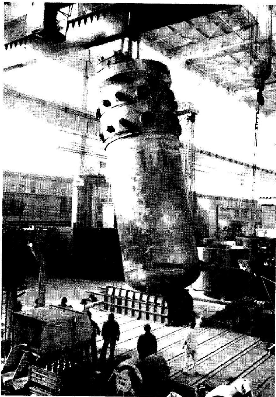
Рис. 5.5. Корпус ядерного реактора ВВЭР-1000
