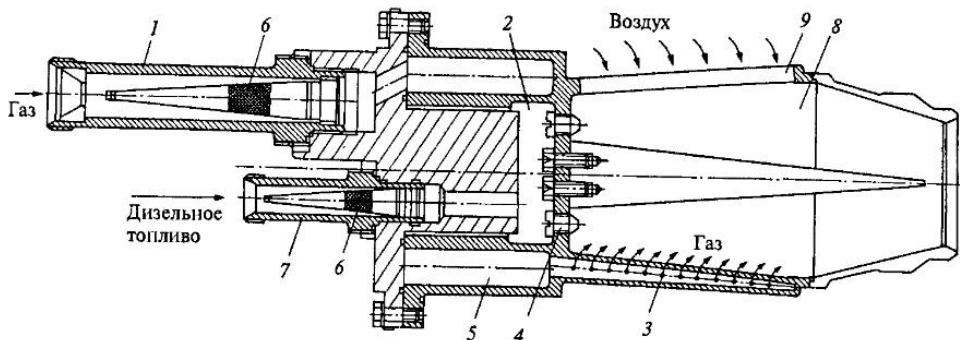
Рис. 7.15. Горелочный модуль трубчато-кольцевой камеры сгорания (проект ЛМЗ-«Авиадвигатель»):
