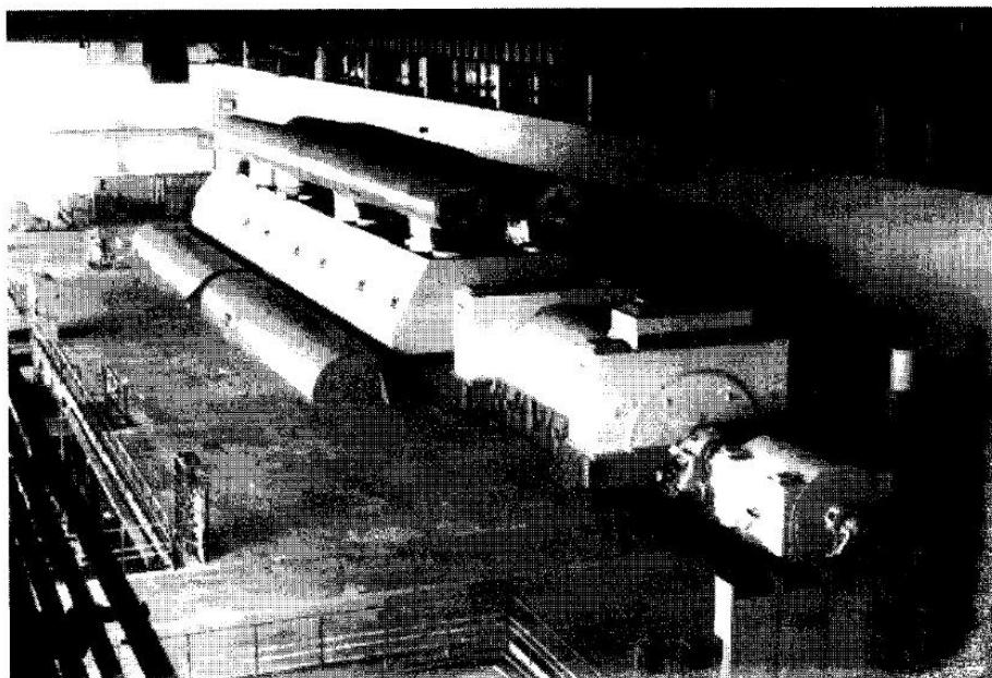
Рис. 2.8. Общий вид турбины мощностью 800 МВт, установленной в машзале ТЭС
