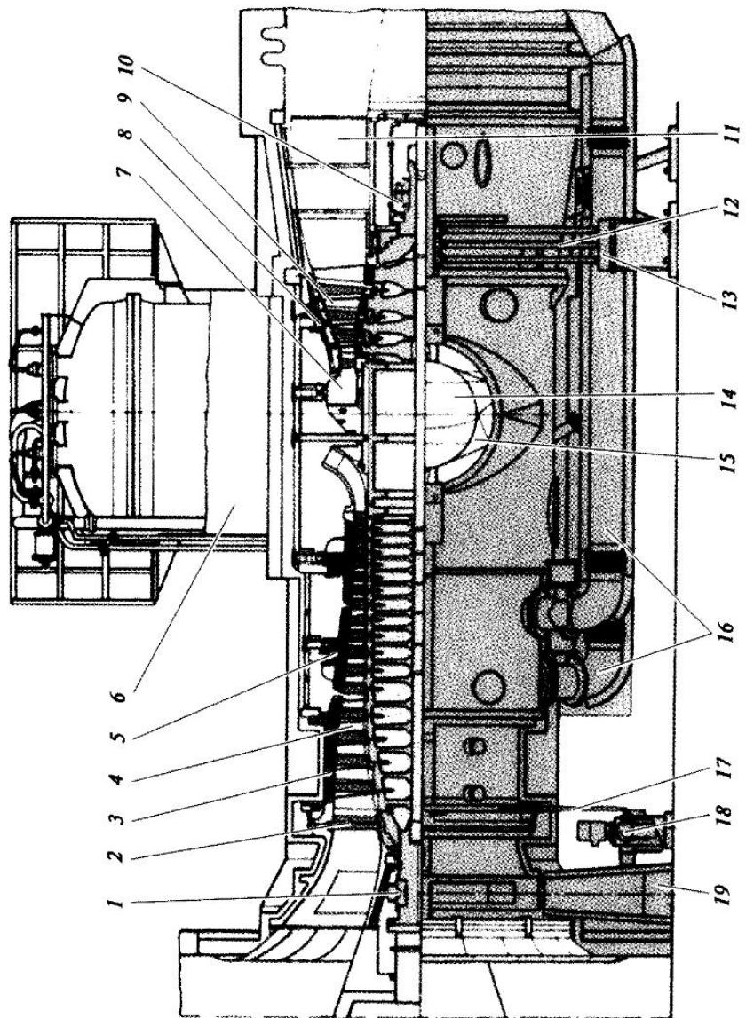
**Рис. 14.2. Продольный разрез ГТУ V94.2:**
