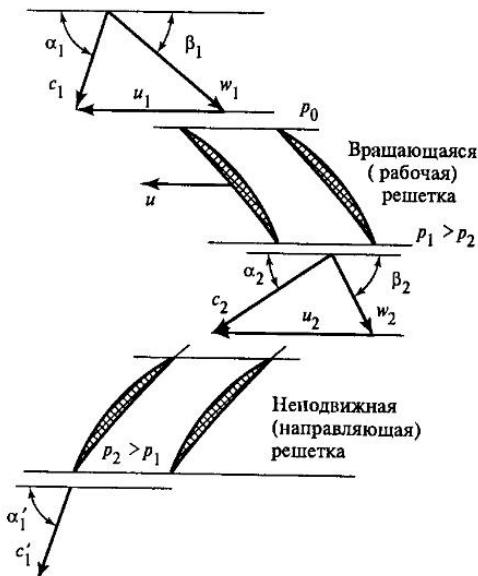
Рис. 7.9. Течение воздуха в компрессорной ступени
