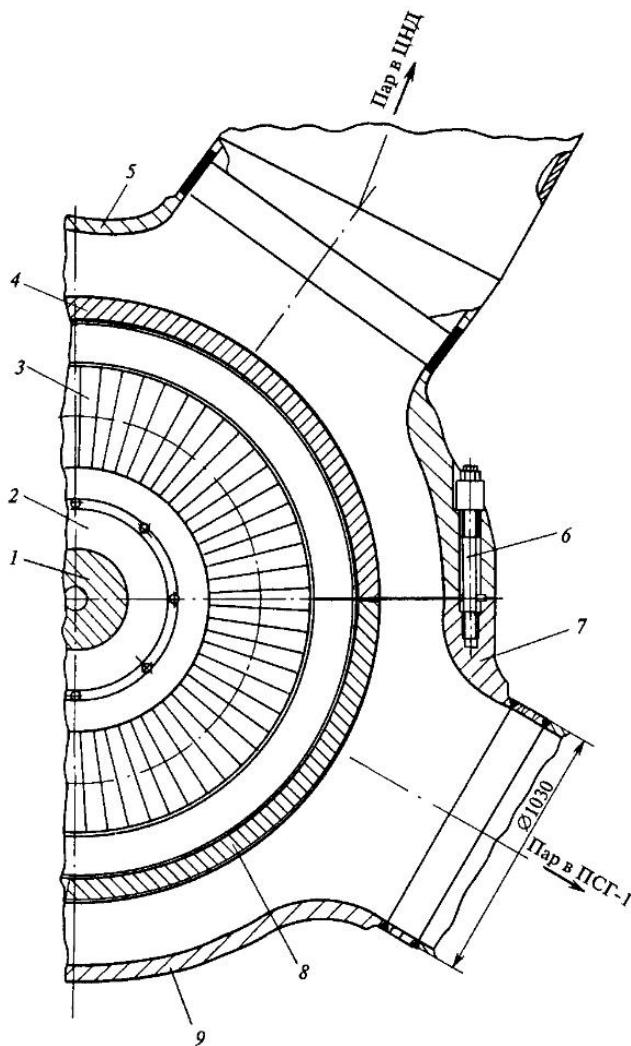
**Рис. 16.3. Поперечный разрез по выходному патрубку ЦВД турбины Т-170-7,8:**
