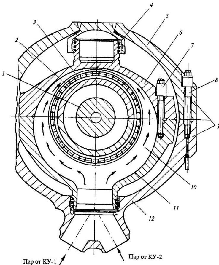
**Рис. 16.2. Поперечный разрез паровой турбины по паропуску:**
