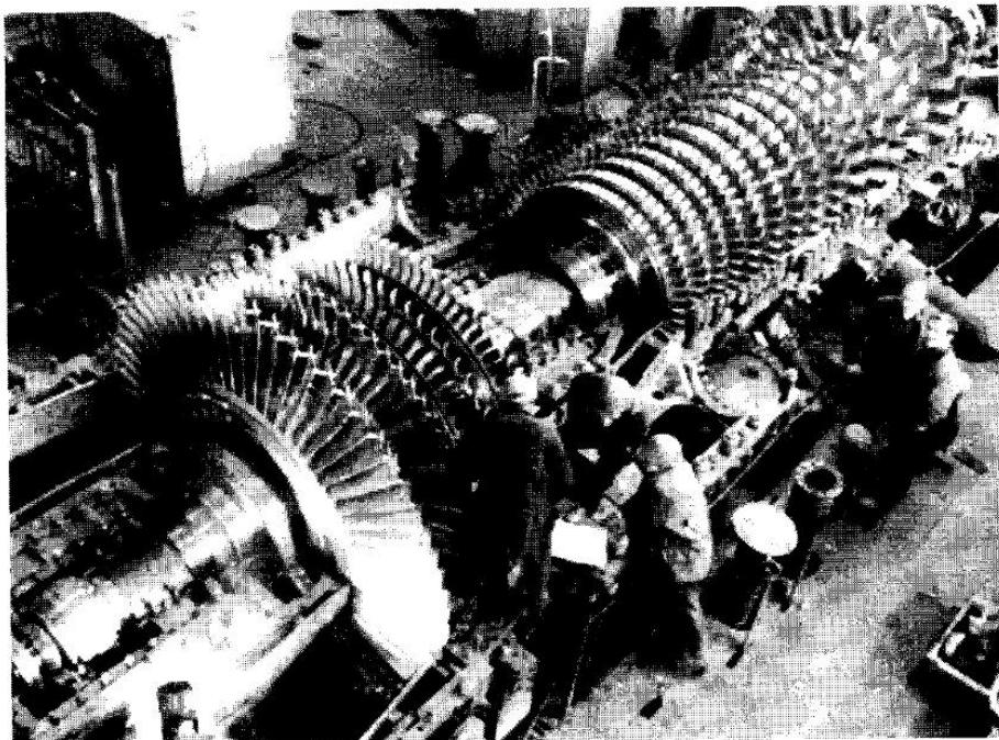
Рис. 11.2. Сборка ГТЭ-150 ЛМЗ на ГРЭС-3 ОАО «Мосэнерго»
