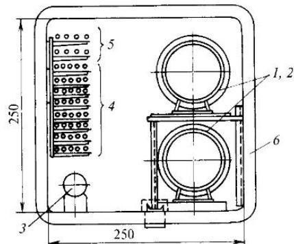
Рис. 3.5. Городской коллектор для тепло-проводов из объемных элементов:
