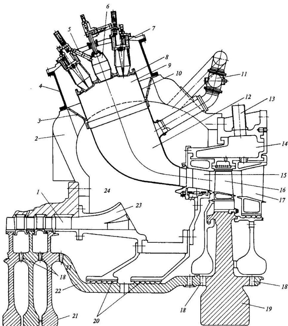
Рис. 7.10. Выходная часть компрессора, трубчато-кольцевая камера сгорания и входная часть газовой турбины (проект ЛМЗ-«Авиадвигатель»):
