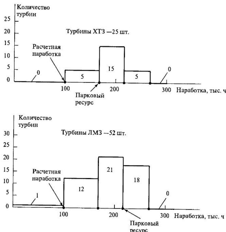
Рис. 9.5. Распределение турбин типа К-300-23,5 по наработке
