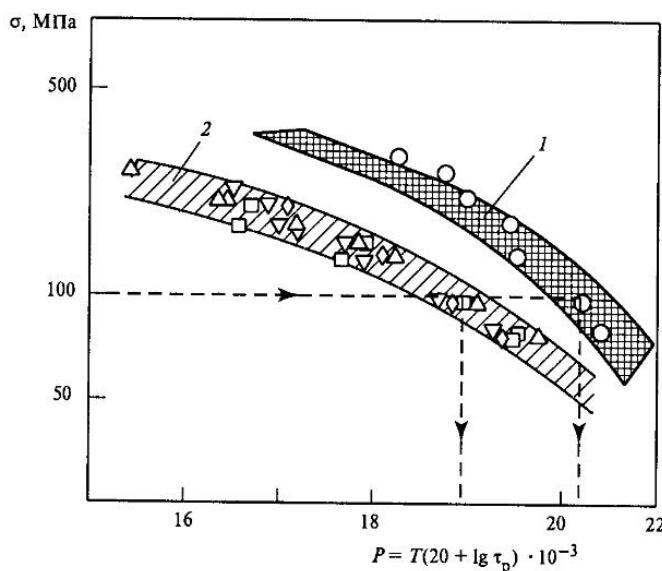
Рис. 12.1. Влияние длительной работы материала ротора при высокой температуре на его длительную прочность:
