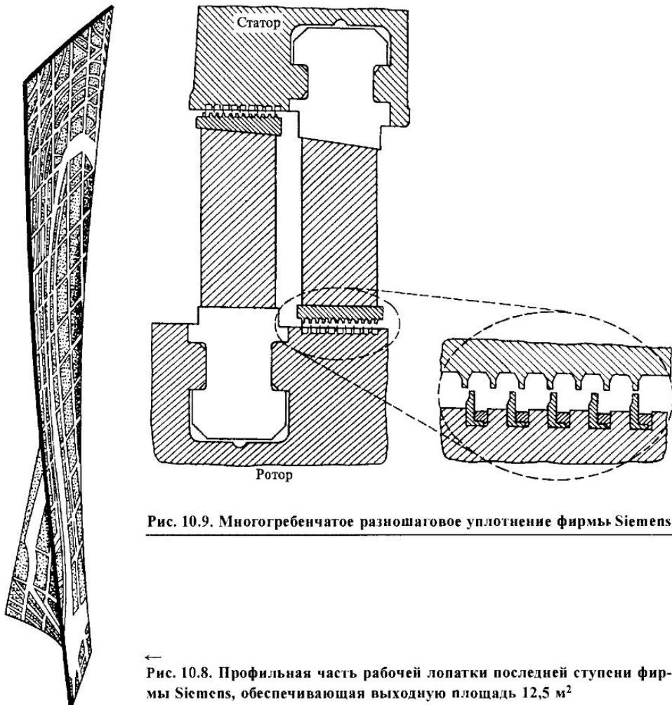
Рис. 10.9. Многогребенчатое разношаговое уплотнение фирмы Siemens
