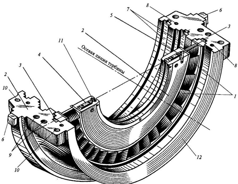
**Рис. 6.3. Диафрагма, помещенная в обойму (пар протекает слева направо):**
