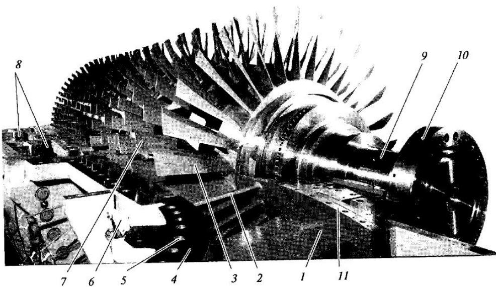
Рис. 7.5. Ротор воздушного компрессора ГТУ, расположенный в опорные подшипники:
