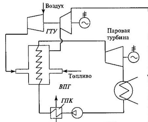
Рис. 8.7. Схема ПГУ с высоконапорным парогенератором
