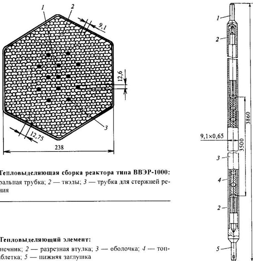
**Рис. 5.6. Термовыделяющая сборка реактора типа ВВЭР-1000:**
