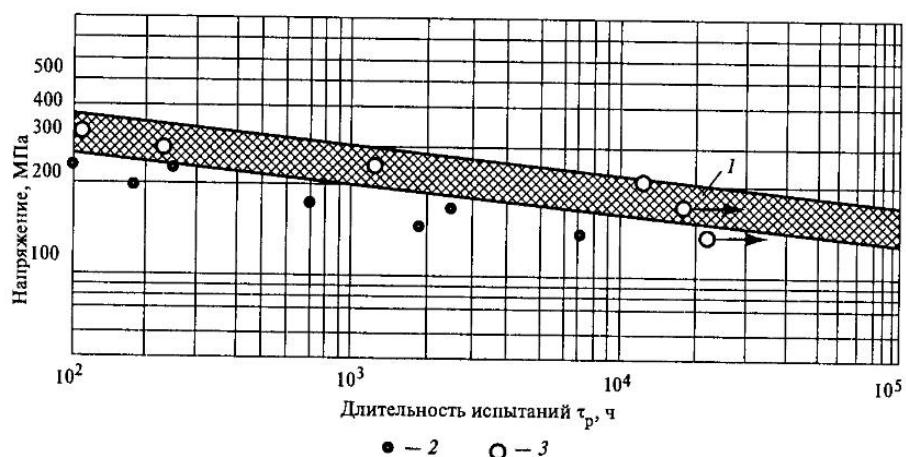
Рис. 12.8. Длительная прочность стали Р2М при 550 °C в исходном состоянии (полоса 1), после 200 тыс. ч эксплуатации (темные символы 2) и после восстановительной термообработки (светлые символы 3) по данным докт. техн. наук В.Ф. Резинских
