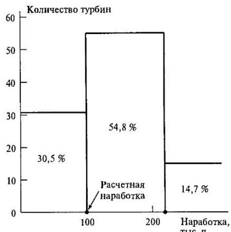
Рис. 9.7. Распределение теплофикационных турбин на начальное давление 130 ат (12,8 МПа) по наработке
