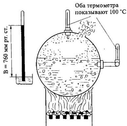
Рис. 1.1. Образование сухого насыщенного пара
