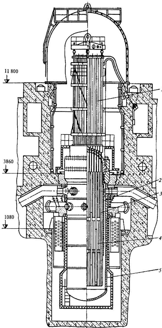
**Рис. 5.10. Реактор ВВЭР-440 в бетонной шахте и с защитным колпаком:**
