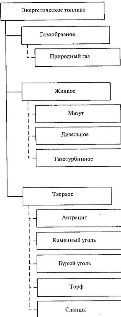
Рис. 1.4. Виды энергетических топлив
