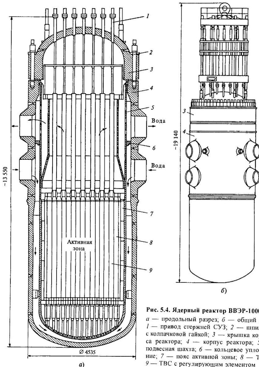
**Рис. 5.4. Ядерный реактор ВВЭР-1000:**
