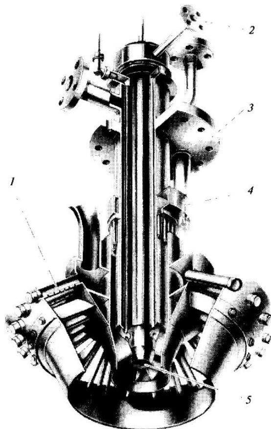
**Рис. 14.8. Внешний вид горелочного модуля камеры сгорания:**
