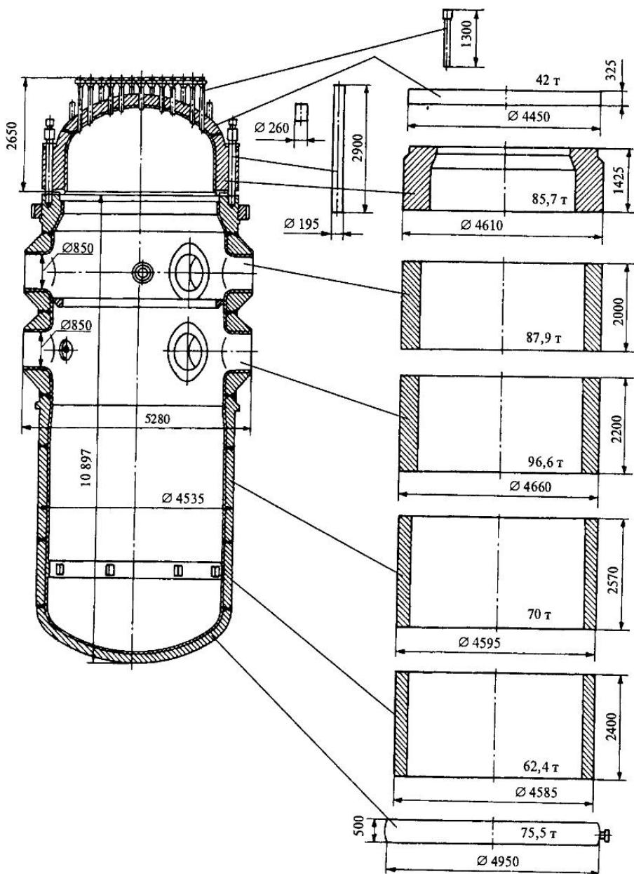
Рис. 5.8. Элементы для изготовления корпуса реактора ВВЭР-1000 с указанием размеров и масс
