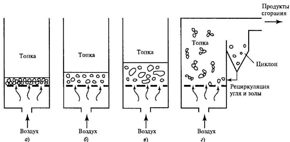
Рис. 11.9. Изменение кипящего слоя при различных количествах воздуха, подаваемого для горения
