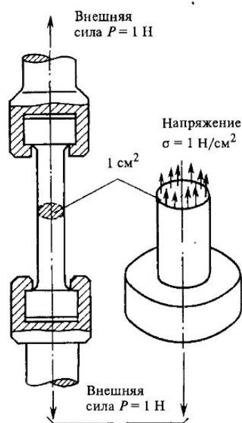
Рис. 1.6. Напряжения в растягиваемом стержне
