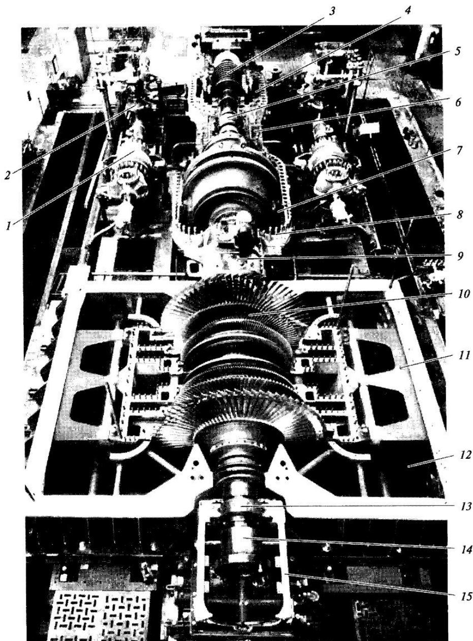
**Рис. 6.10. Мощная трехцилиндровая турбина на заводском сборочном стенде:**
