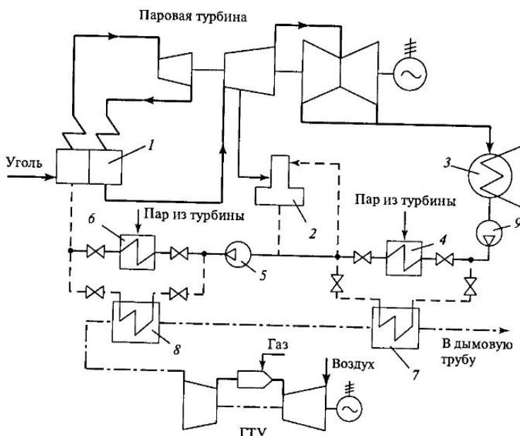
Рис. 8.6. Принципиальная схема ПГУ с вытеснением регенерации:
