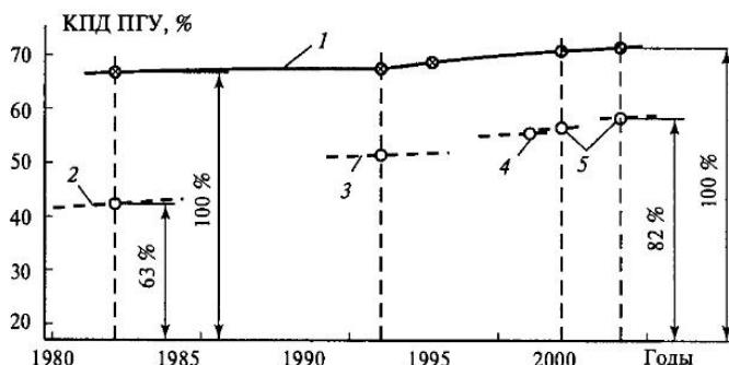
Рис. 8.14. Сравнение экономичности ПГУ разных типов с теоретической (по данным фирмы Siemens):
