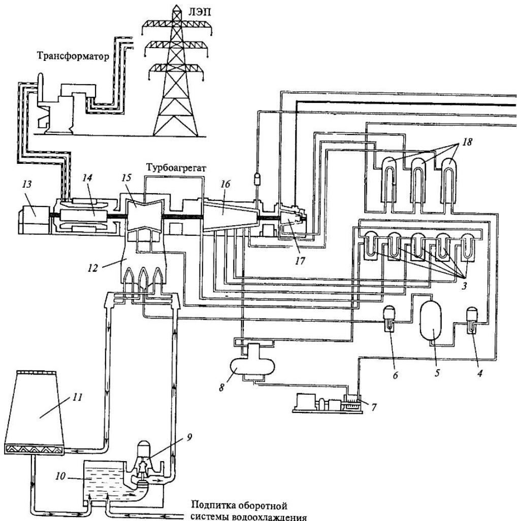
Рис. 2.2. Технологическая схема ТЭС,
