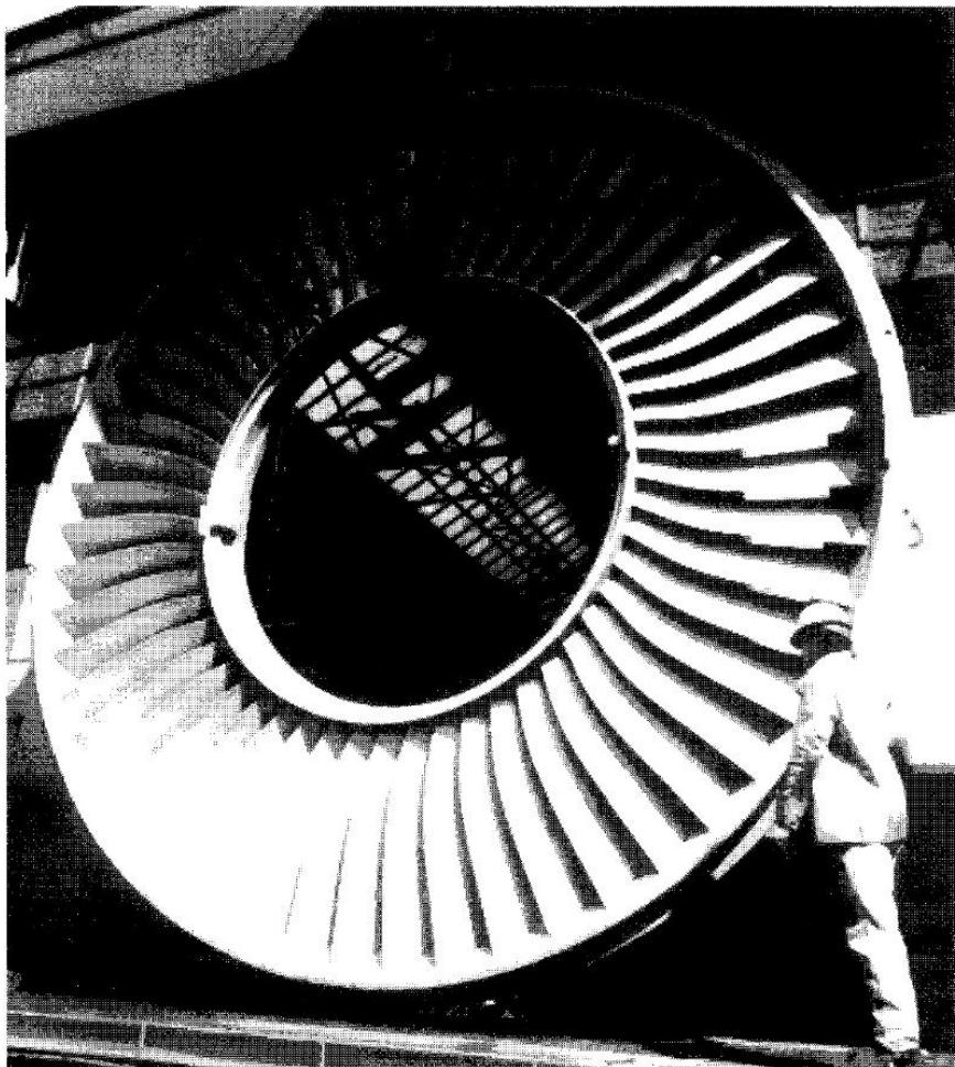
Рис. 10.3. Диафрагмы с саблевидными лопатками турбин фирмы Siemens
