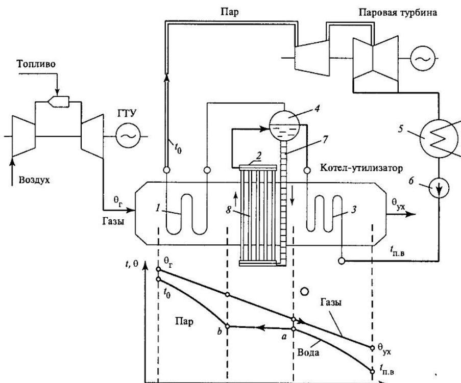
Рис. 8.1. Принципиальная схема простейшей ПГУ утилизационного типа:
