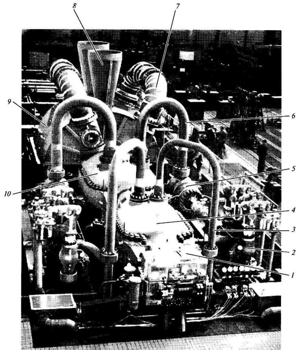
**Рис. 2.9. Трехцилиндровая турбина на сборочном стенде турбинного завода**
