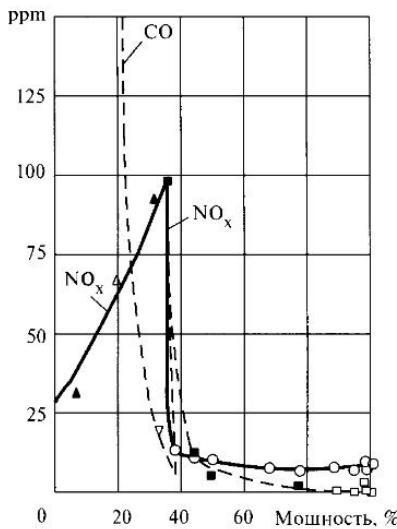
Рис. 14.10. Зависимость вредных выбросов камеры сгорания от мощности электрогенератора и режима горения
