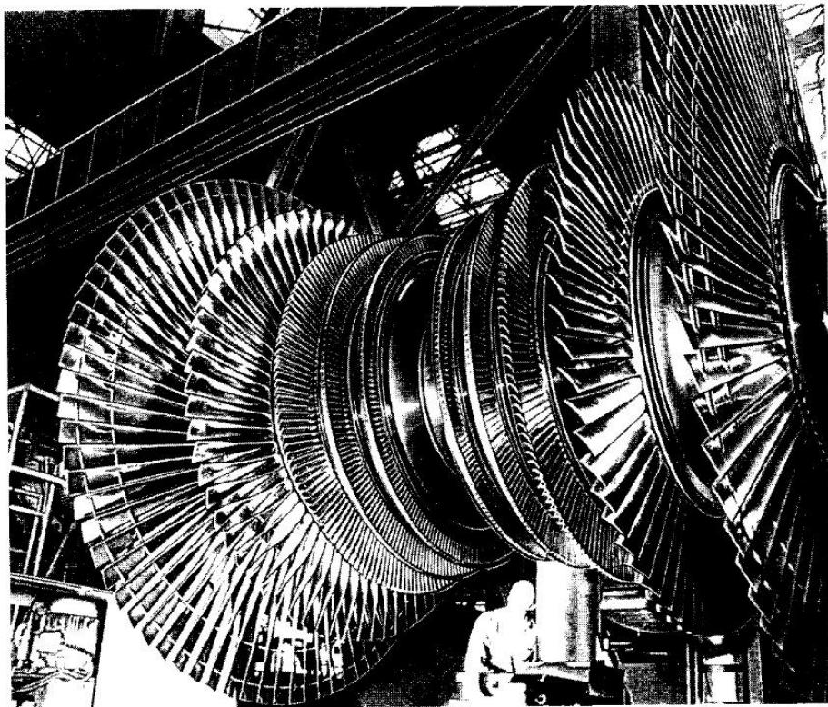
Рис. 6.12. Ротор двухпоточного ЦНД мощной турбины
