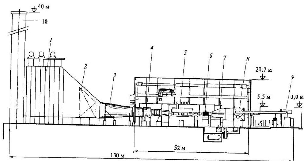
Рис. 8.11. Одновальная ПГУ фирмы Siemens с ГТУ V94.3A:
