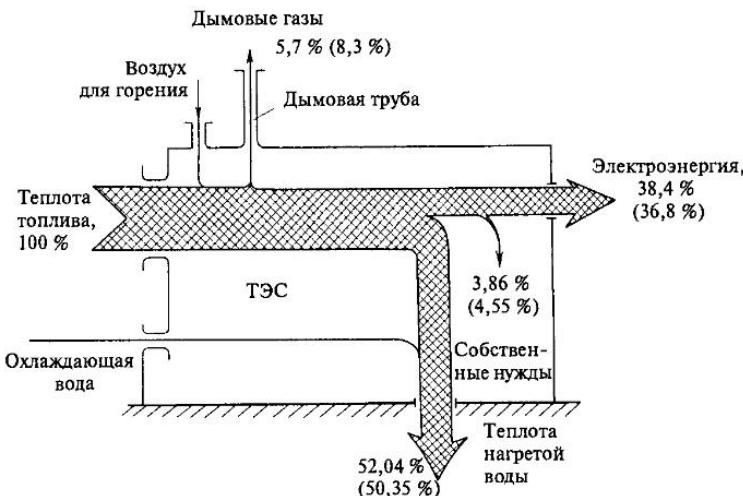
Рис. 2.1. Тепловой баланс газомазутной и пылеугольной (числа в скобках) ТЭС
