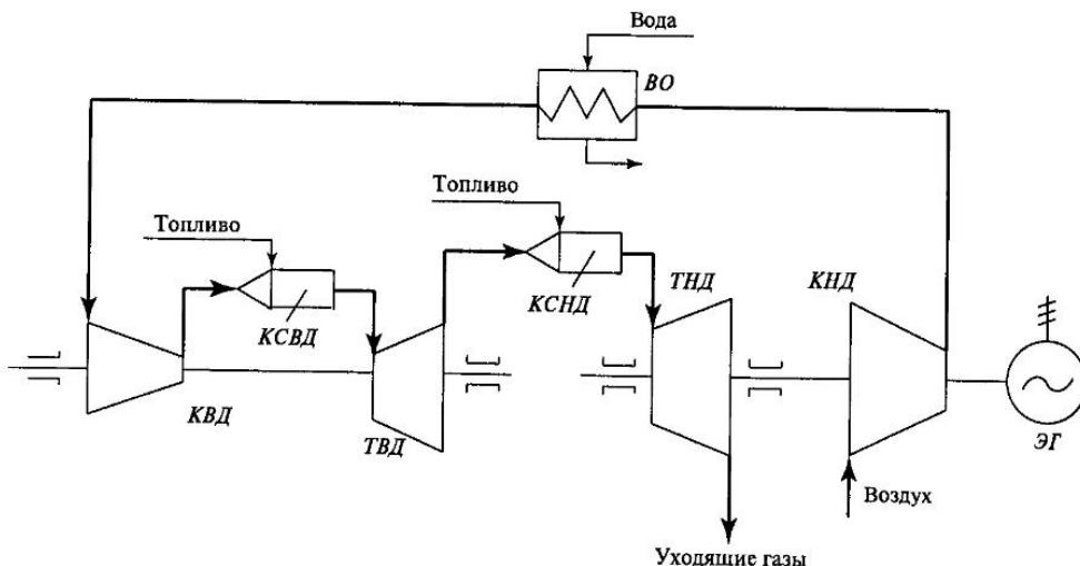
Рис. 7.3. Схема газотурбинной установки ГТ-100-750 ЛМЗ
