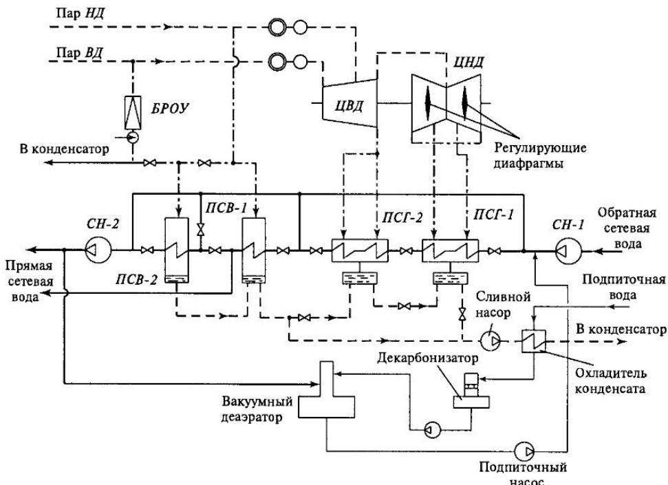
Рис. 16.7. Принципиальная тепловая схема водоподогревательной установки энергоблока ПГУ-450Т
