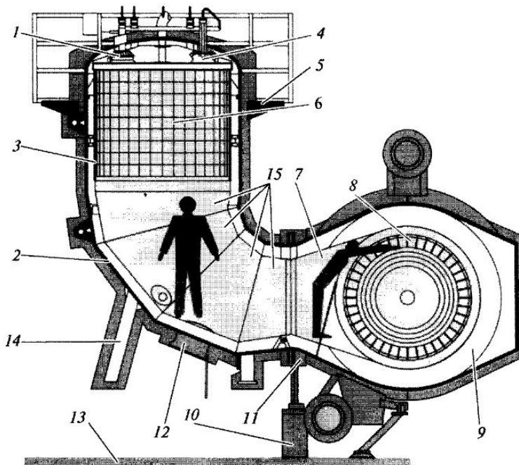
**Рис. 14.5. Сочленение камеры сгорания и газовпускной части газовой турбины (правая камера сгорания не показана):**
