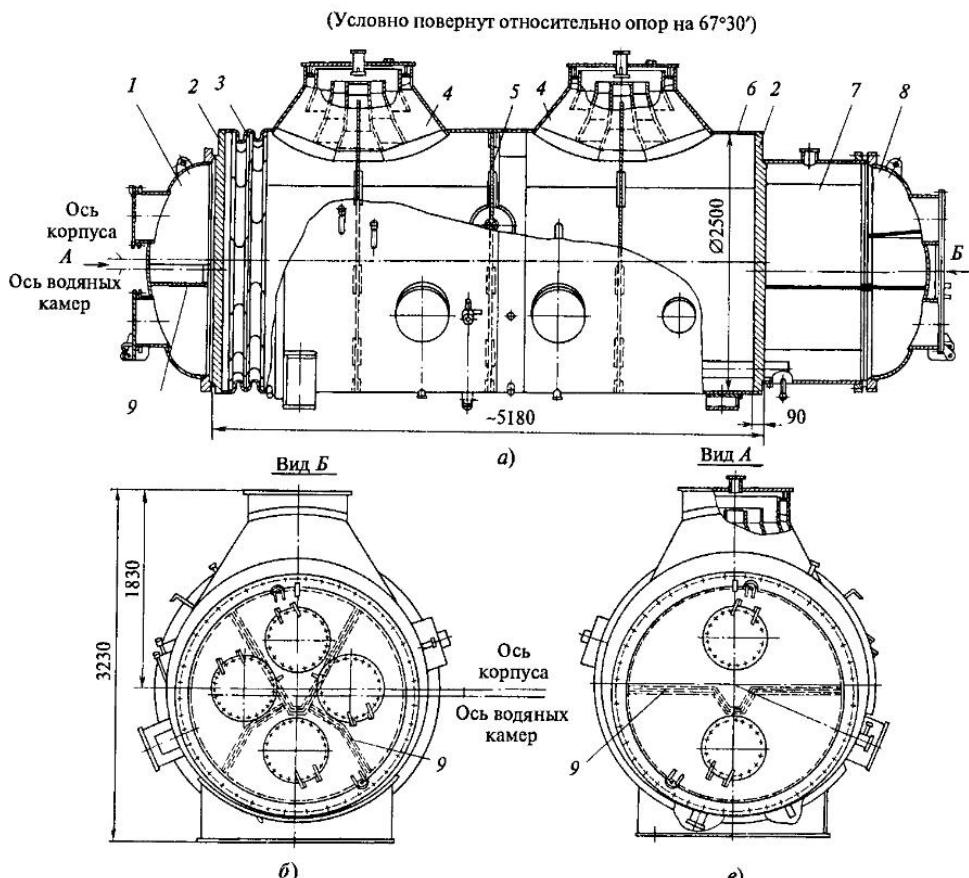
**Рис. 4.4. Продольный разрез горизонтального сетевого подогревателя:**
