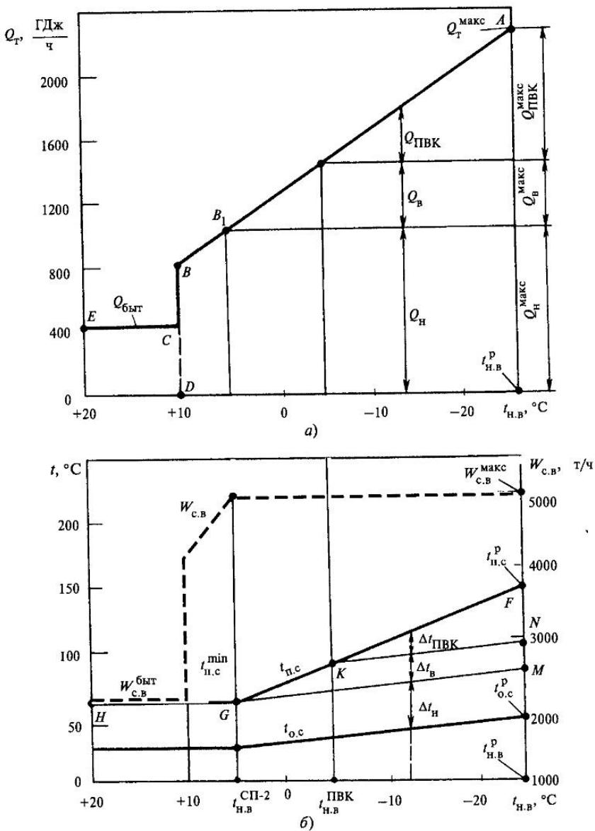
Рис. 4.2. Потребление тепла (а) и температурный график теплосети (б)
