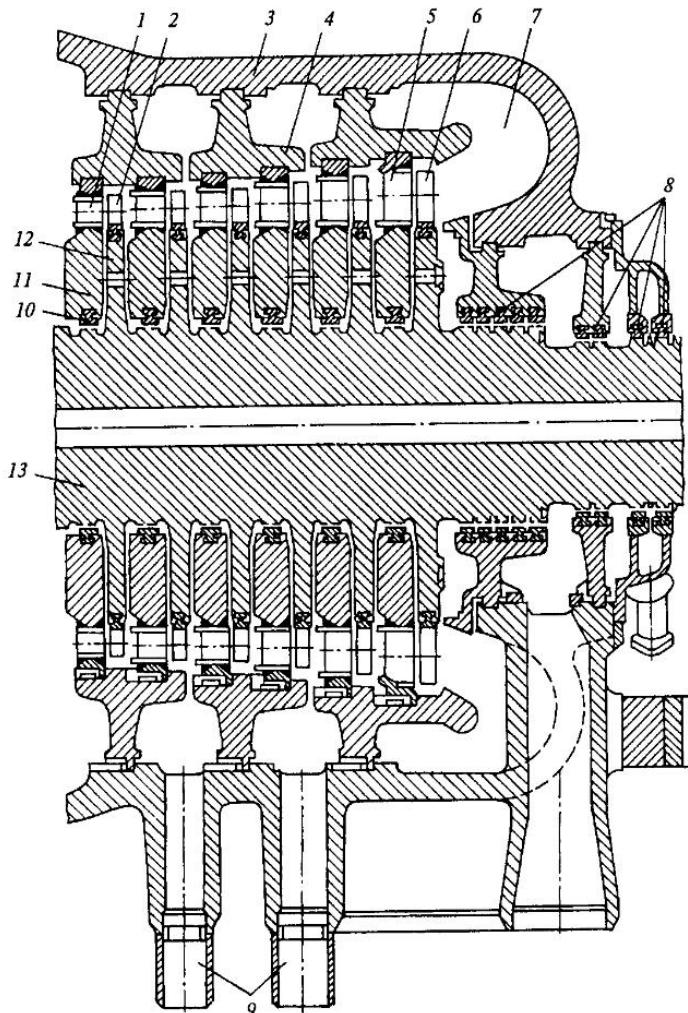
Рис. 6.2. Фрагмент проточной части турбины с выходным патрубком:
