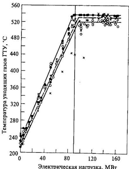
Рис. 13.3. Зависимость температуры уходящих газов ГТУ от ее электрической нагрузки (опытные данные)
