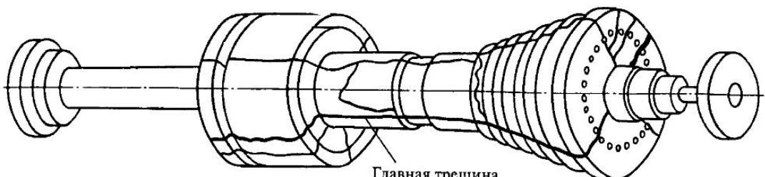
Рис. 12.5. Хрупкое разрушение ротора американской турбины
