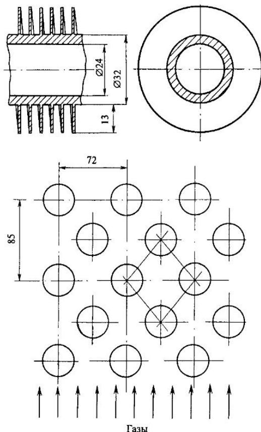
Рис. 15.5. Трубы с оребрением для котлов-утилизаторов
