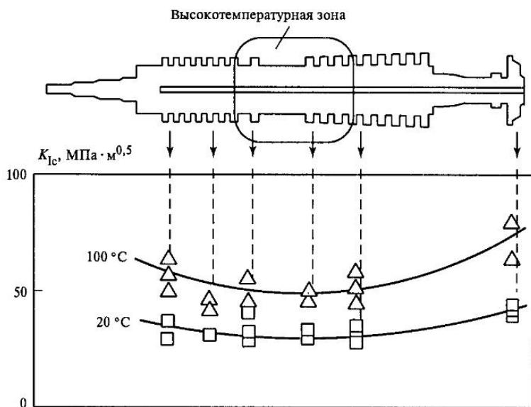
Рис. 12.2. Деградация сопротивления хрупкому разрушению роторной стали вследствие длительной эксплуатации (испытания образцов при 20 и 100 °C)
