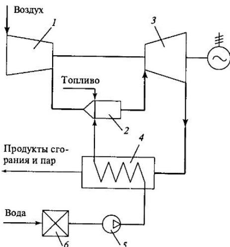
Рис. 8.4. Принципиальная схема монарной ПГУ:
