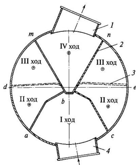
Рис. 4.5. Схема движения воды в четырехходовом горизонтальном сетевом подогревателе (римские цифры — ходы сетевой воды):
