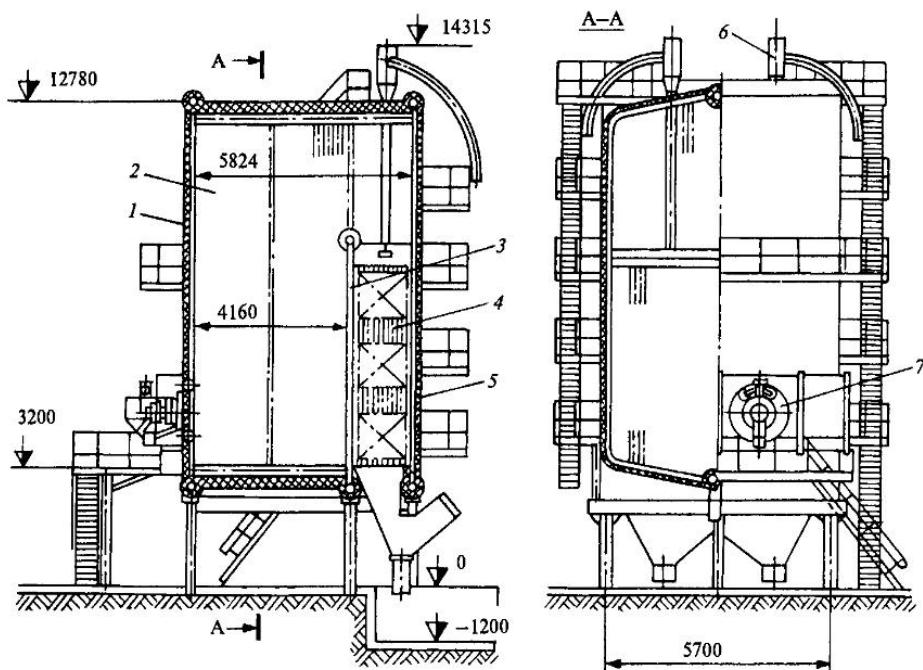
Рис. 3.3. Устройство водогрейного котла KVGM-50:
