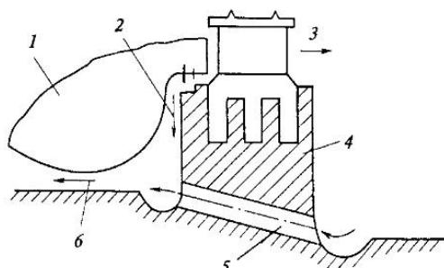
Рис. 11.7. Охлаждение диска и вала под ним «холодным» паром из камеры регулирующей ступени:
