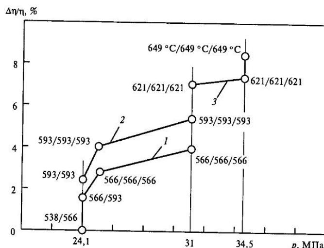
Рис. 10.11. Относительное повышение КПД турбинной установки по отношению к КПД турбины с параметрами 24,1 МПа, 538 °C/566 °C (по данным японских энергетиков):
