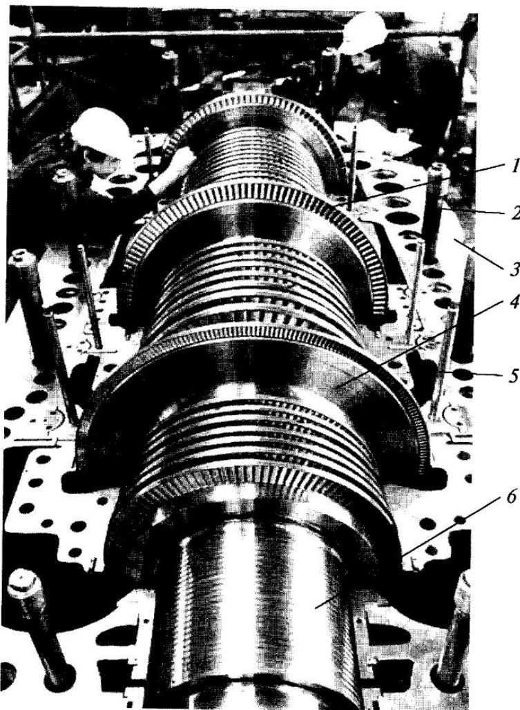
Рис. 6.9. Установка зазоров в проточной части турбины:
