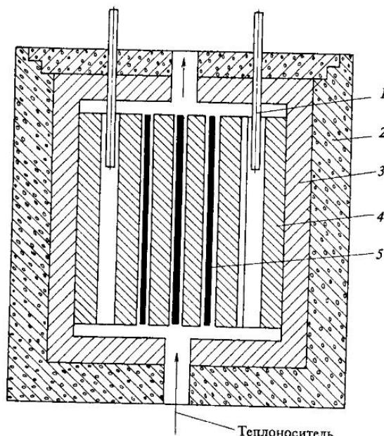
**Рис. 5.3. Схема ядерного реактора на тепловых нейтронах:**
