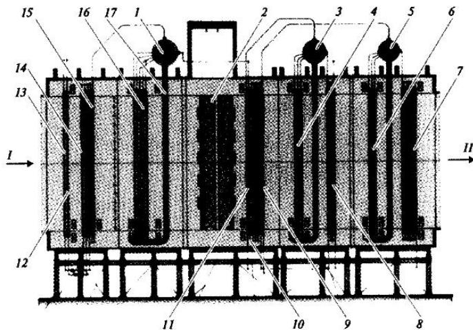
**Рис. 8.12. Конструкция горизонтального трехконтурного котла-утилизатора японской фирмы Toshiba:**
