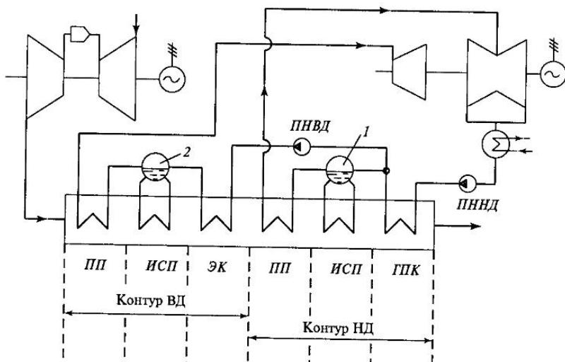
Рис. 8.8. Схема двухконтурной утилизационной ПГУ:
