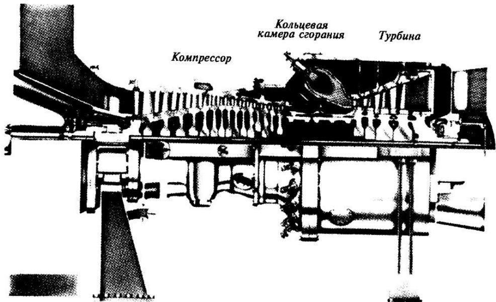
Рис. 14.17. Конструкция ГТУ 94.3А фирмы Siemens
