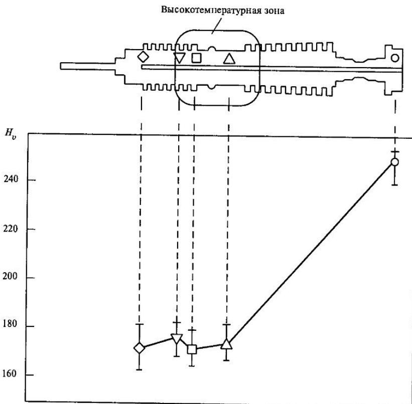
Рис. 12.3. Деградация твердости (по Виккерсу) роторной стали вследствие длительной эксплуатации
