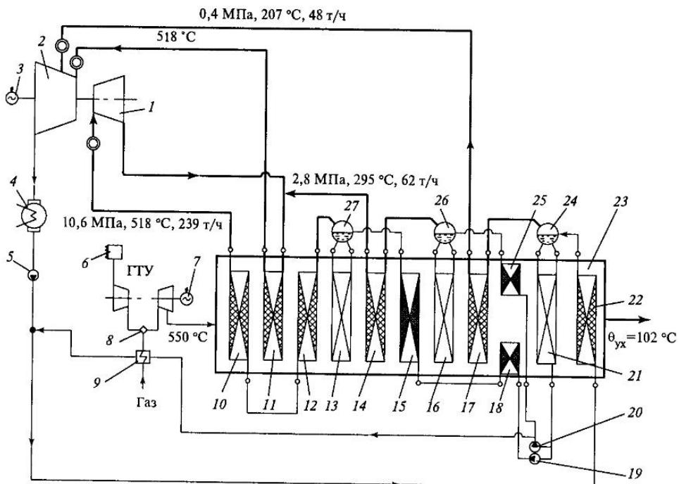
**Рис. 8.9. Принципиальная схема трехконтурной ПГУ с промежуточным перегревом пара (разработка фирмы Westinghouse):**
