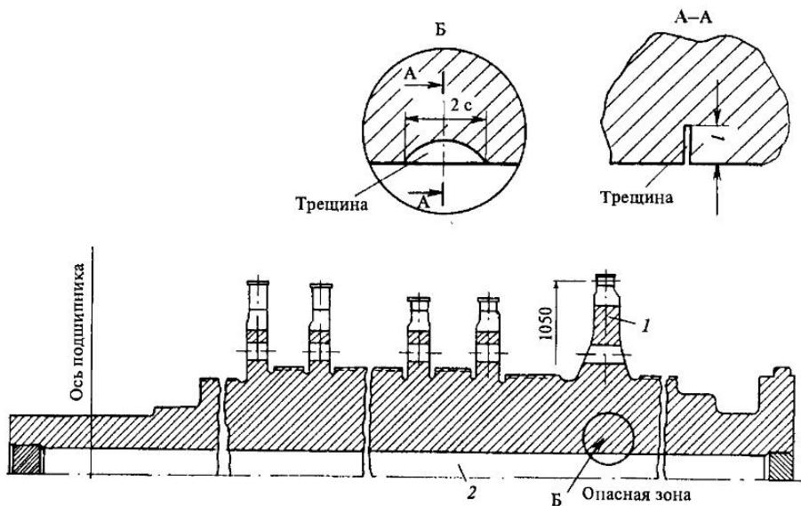
**Рис. 12.6. Опасная зона ротора ЦВД турбины и схема дефекта (трещины):**
