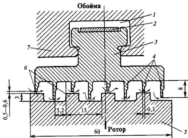
**Рис. 6.8. Лабиринтовое уплотнение для валов турбин:**
