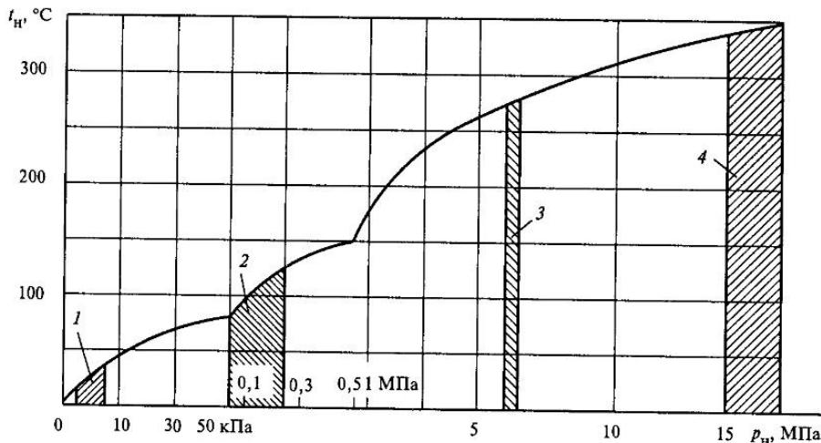
Рис. 1.2. Связь между температурой и давлением кипения (конденсации, испарения) с указанием областей работы:
