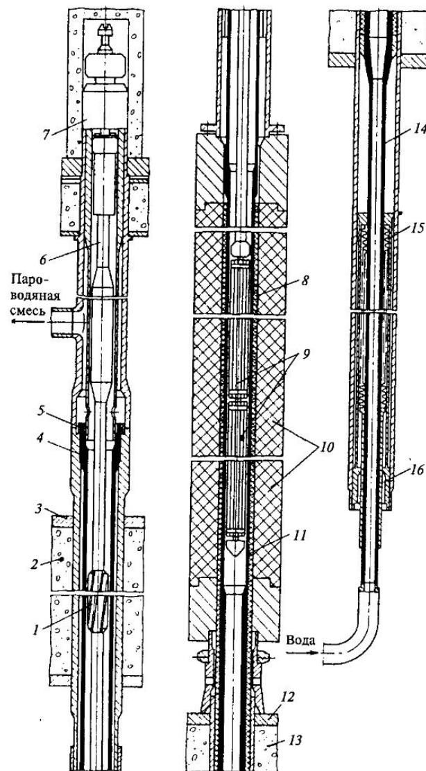
**Рис. 5.12. Технологический канал реактора РБМК-1000:**
