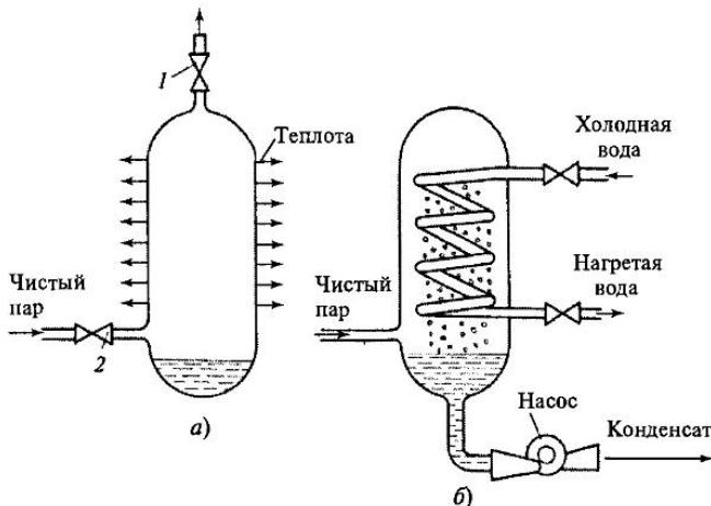
Рис. 1.3. Принцип работы теплообменников тепловых электростанций, использующих теплоту конденсации пара
