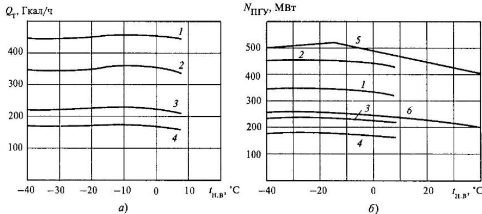
Рис. 16.4. Зависимости максимальных тепловых (а) и электрических (б) нагрузок ПГУ-450Т от температуры наружного воздуха в зависимости от состава работающего оборудования:
