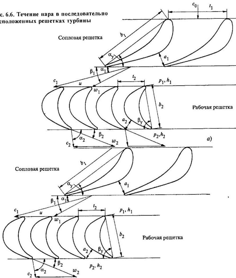
нии  $w_2 \approx w_1$ . Но так как, рабочие лопатки имеют скорость  $u$ , то скорость выхода пара относительно корпуса будет равна  $c_2 \approx c_0$ . Далее процесс повторяется в проточной части второй ступени и так до тех пор, пока пар не попадет в конденсатор.
