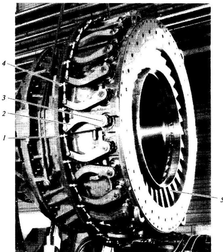
**Рис. 7.7. Устройство входного поворотного направляющего аппарата ГТУ фирмы General Electric:**
