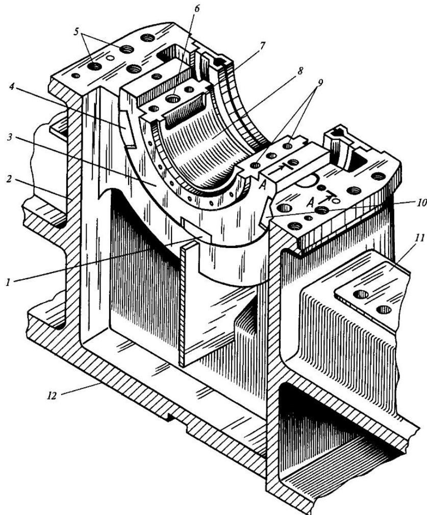
**Рис. 6.13. Опора валопровода:**
