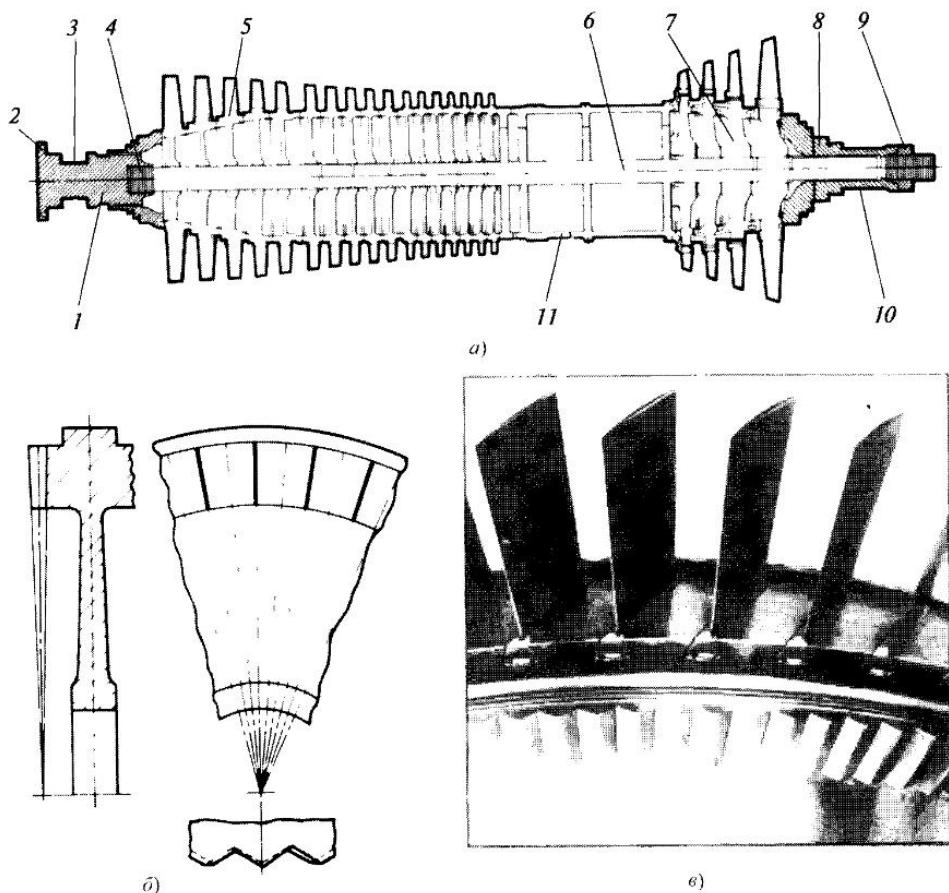
Рис. 7.21. Ротор ГТУ фирмы Siemens:
