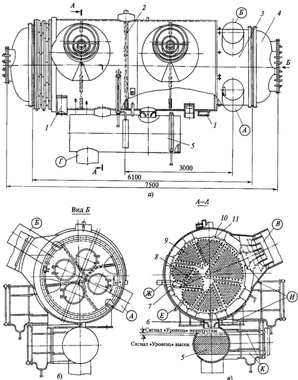
**Рис. 4.6. Общий вид подогревателя ПСГ-1300-3-8-1 в рабочем положении:**
