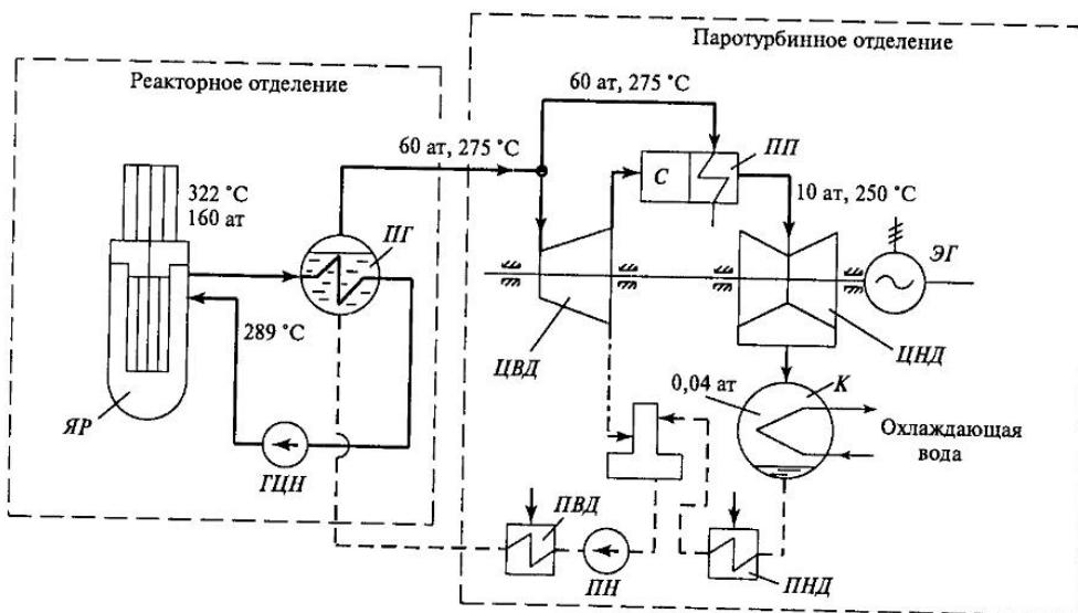
Рис. 5.14. Схема двухконтурной АЭС с водо-водяным реактором типа ВВЭР (приведенные цифры относятся к ВВЭР-1000)
