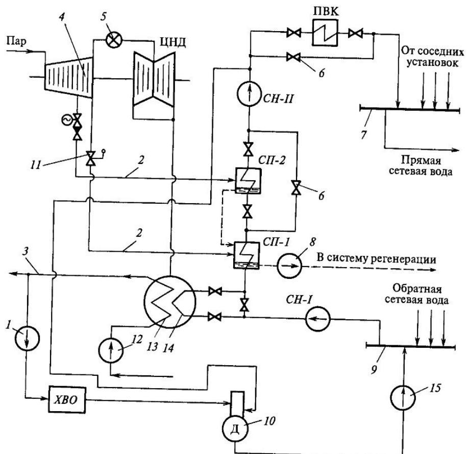
Рис. 4.1. Принципиальная схема теплофикационной установки и ее включение в общую схему подогрева сетевой воды на ТЭЦ:
