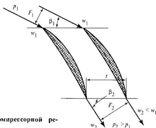
**Рис. 7.8. Канал компрессорной решетки**
